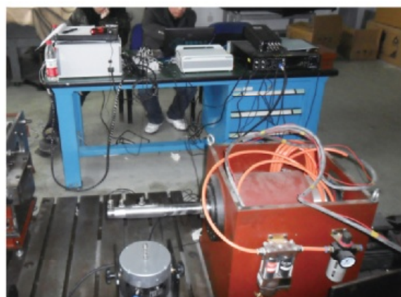
自由梁实时扫频模态分析试验现场
